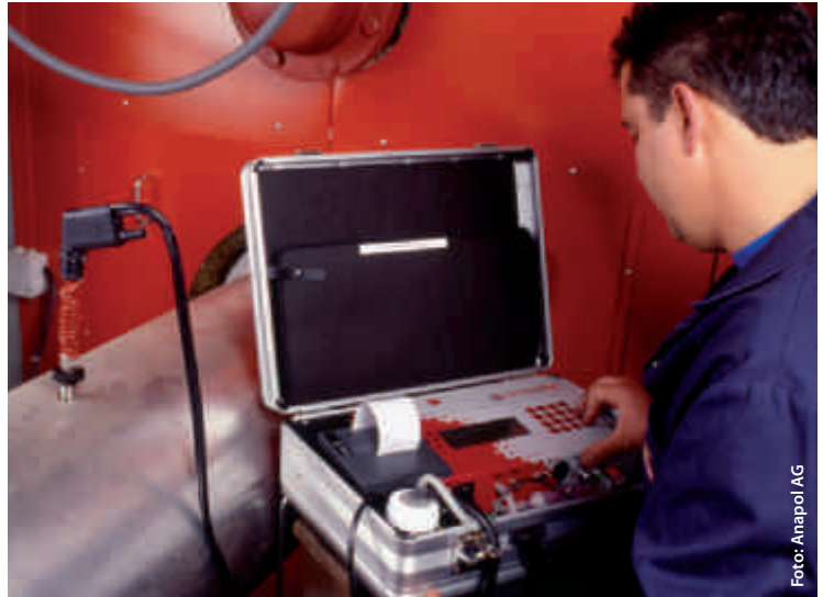
Messung der Abgase bei der Feuerungskontrolle
